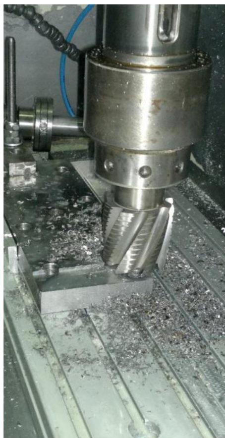
FOTO DI ESEMPIO: SI ESEGUONO LAVORAZIONI MECCANICHE SU PROFILI ESTRUSI IN ALLUMINIO
