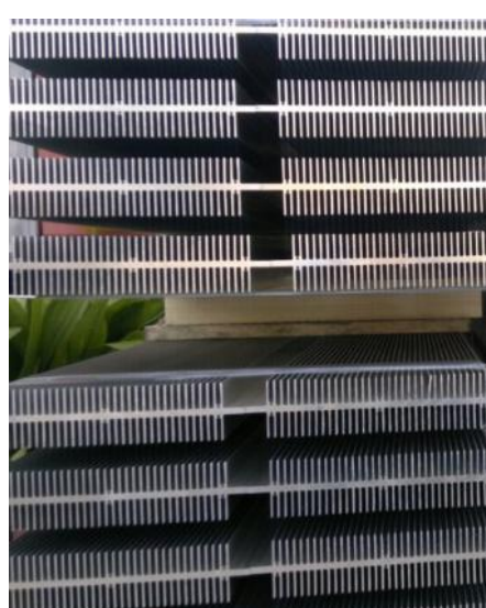
FOTO DI ESEMPIO: DISSIPATORI A DOPPIO PETTINE DI GRANDI DIMENSIONI (mm 300 x 65mm kg/mt 16 circa)
