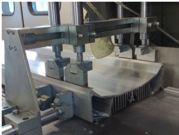
FOTO DI ESEMPIO: TAGLIO PROFILO IN ALLUMINIO ESTRUSO PER LED DI GROSSE DIMENSIONI
