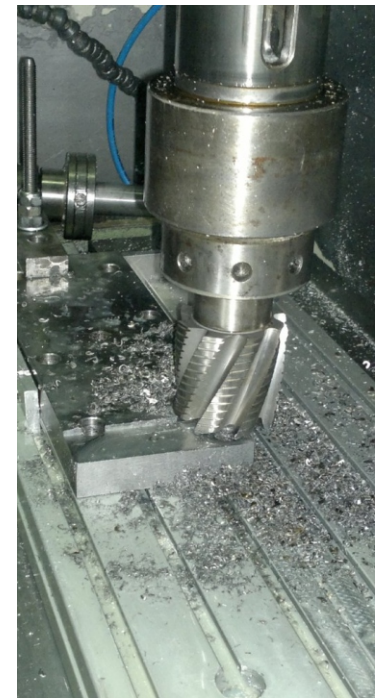
FOTO DI ESEMPIO: SI ESEGUONO LAVORAZIONI MECCANICHE SU PROFILI ESTRUSI IN ALLUMINIO
