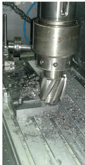
BEISPIELFOTOS: SIE WERDEN AUSGEFÜHRT MECHANISCHES ARBEITEN AN EXTRUDIERTEN ALUMINIUMPROFILIEN
