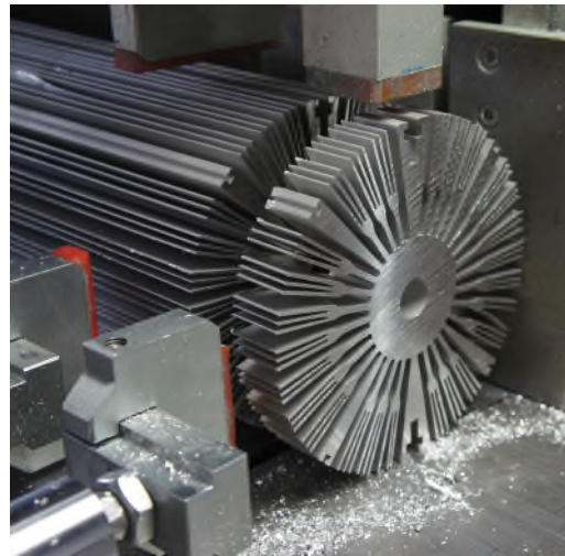
BEISPIELFOTO: KÜHLKÖRPER ZUSCHNEIDEN „BLUME“ AUCH GRÖßER ABMESSUNGEN
