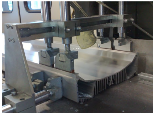
BEISPIELFOTO: SCHNEIDEN EINES EXTRUDIERTEN ALUMINIUMPROFILS FÜR GROßE ABMESSUNGEN LEDs
