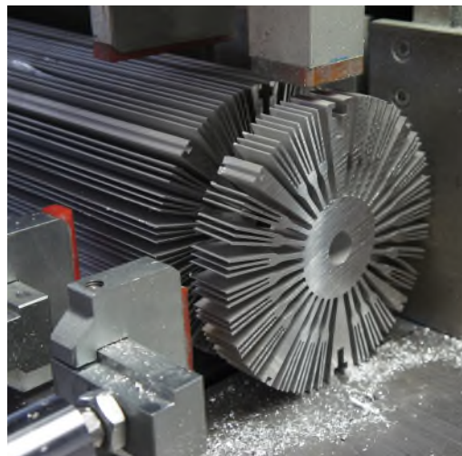
EXEMPLE DE PHOTO : DÉCOUPE DES DISSIPATEURS DE CHALEUR SUR MESURE « FLEUR » MÊME DE GRANDES DIMENSIONS
