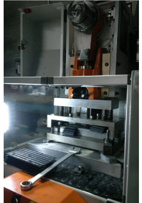
EXEMPLES DE PHOTOS : ILS SONT EXÉCUTÉS OPÉRATIONS DE SUPPRESSION SUR PROFILÉS EN ALUMINIUM EXTRUDÉ
