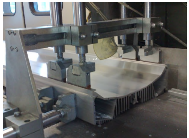
EXEMPLE DE PHOTO : DÉCOUPE DE PROFILÉ EN ALUMINIUM EXTRUDÉ POUR LED DE GRANDES DIMENSIONS
